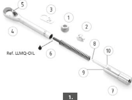
FR: 1. Douille 2. Cliquet 3. Copercchio 4. Tête/manche 5. Vis 6. Ressort/butée 7. Poullet de réglage 8. Embout 6 pans 9. Rondelle (PPS-Sulfure de Polyphénylène) 10. Frein (PTFE-Teflon) IT: 1. Anello 2. Nottolino 3. Coperchio 4. Testina/manico 5. Vite 6. Molla/finecorsa 7. Regolatore 8. Punta esagonale 9. Rondella (PPS-Solfuro di Polifenilene) 10. Freno (PTFE-Teflon)
